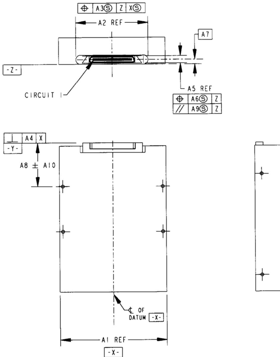
FIGURE 14-1 SCA-2 CONNECTOR LOCATION
