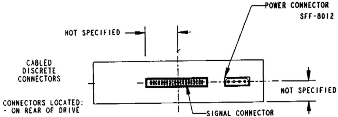
FIGURE 7-1 DISCRETE CONNECTOR ORIENTATION
