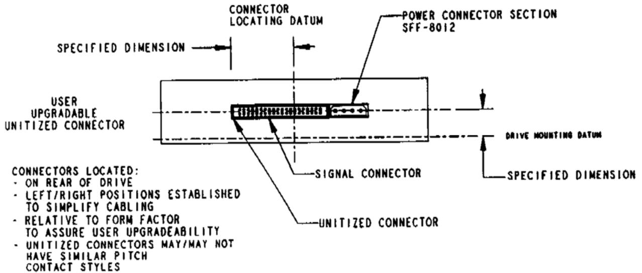
FIGURE 7-3 UPGRADABLE UNITIZED CONNECTOR ORIENTATION
