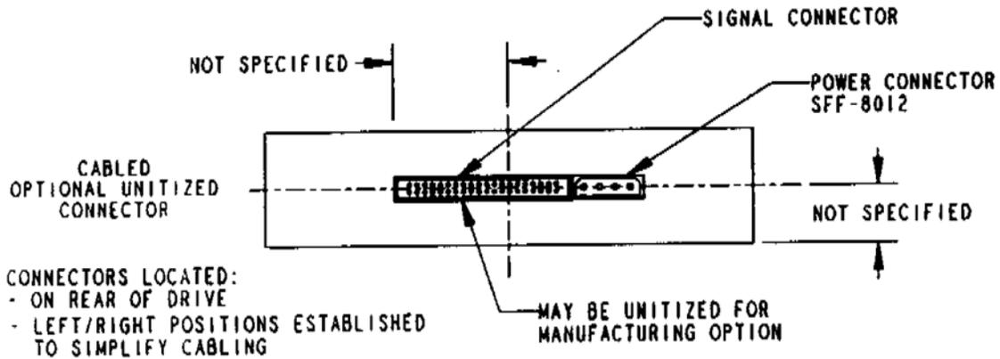
FIGURE 7-2 UNITIZED CONNECTOR ORIENTATION
