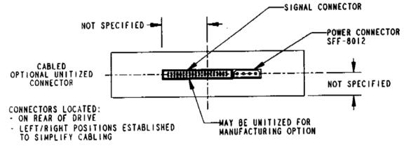
FIGURE 7-2 UNITIZED CONNECTOR ORIENTATION
