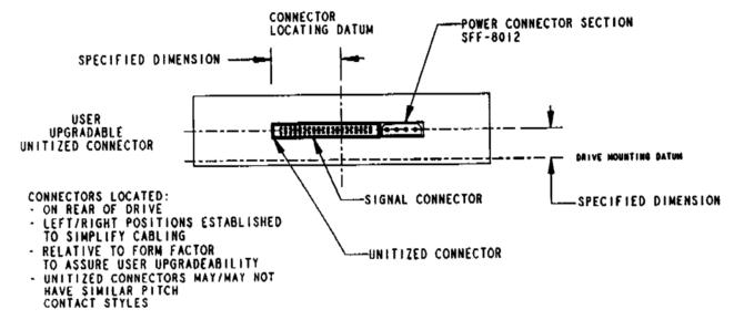
FIGURE 7-3 UPGRADABLE UNITIZED CONNECTOR ORIENTATION
