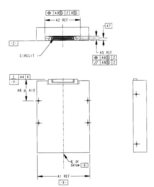
FIGURE 14-1 SCA-2 CONNECTOR LOCATION
