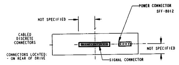
FIGURE 7-1 DISCRETE CONNECTOR ORIENTATION
